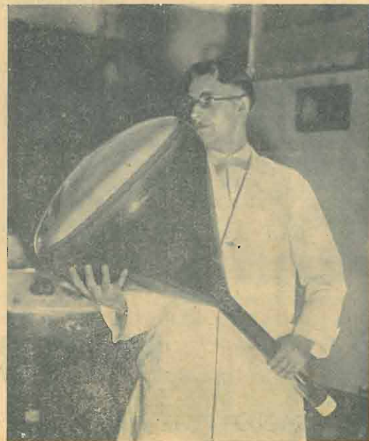
a destra: Un tubo catodico Telefunken del diametro di 50 cm. Immagini di 37x27.
